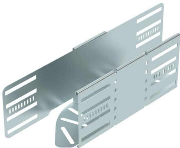
Winkelverstellbarer Bogen zum Erstellen einer horizontalen Abzweigung. Formteil für rast- und schraubbare Kabelrinnen Seitenhöhe 110 mm. Einstellbarer Winkel 0 - 90°. Schraubenlose Montage mit Doppelklemmen oder Schraubverbindung mit Flachrundschrauben FRS und Kombimuttern M6. Einsetzbar im Innenbereich. Befestigungsmaterial muss separat bestellt werden.
