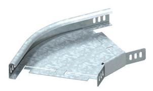
Bogen 45°, horizontal, für alle Kabelrinnentypen mit der Seitenhöhe 35 mm. Der Winkelverbinder WKV 35 ist für 90°-Bögen vorgesehen und wird vor Ort auf 45° angepasst. Das Formteil wird in unmontiertem Zustand geliefert. Inklusive anteiligem Befestigungsmaterial.
