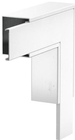
Flachwinkel mit intumeszierendem Brandschutzgewebe für Installationskanal PY-ROLINE® Rapid PLM. Geeignet für die direkte Wand- und Deckenmontage, Montage unterhalb von Systemböden und auf Tragsystemen. Werkzeuglose Stoßstellenmontage mit Stoßstellenverbinder PLM SI. Der Deckel wird werkzeuglos aufgerastet und ermöglicht eine schnelle Revision und Nachbelegung. Deckelüberstand ermöglicht versetzte Deckelmontage für durchgängigen Potentialausgleich der gesamten Kanalstrecke.
