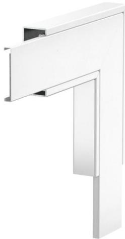
Flachwinkel mit intumeszierendem Brandschutzgewebe für Installationskanal PY-ROLINE® Rapid PLM. Geeignet für die direkte Wand- und Deckenmontage, Montage unterhalb von Systemböden und auf Tragsystemen. Werkzeuglose Stoßstellenmontage mit Stoßstellenverbinder PLM SI. Der Deckel wird werkzeuglos aufgerastet und ermöglicht eine schnelle Revision und Nachbelegung. Deckelüberstand ermöglicht versetzte Deckelmontage für durchgängigen Potentialausgleich der gesamten Kanalstrecke.
