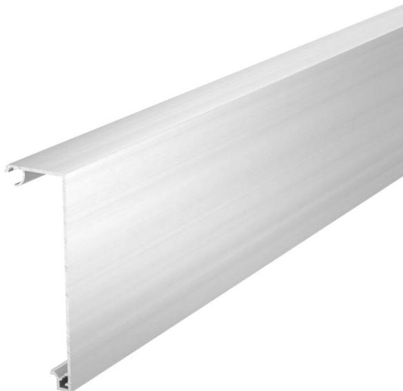
Kanalabdeckung zur Erstellung eines Design-Geräteeinbaukanals der Serie GAD. Designausführung "Style" zur vollständigen Abdeckung der Systemöffnung und der Schalt- und Steckgeräte. Die Oberteiladapter GAD OTA sind zwingend erforderlich und sollten im max. Abstand von 50 cm auf der Kanalstrecke eingeplant werden. Zwischen den Kanalabdeckungen muss ein Distanzstück GAD OTD gesetzt werden.
