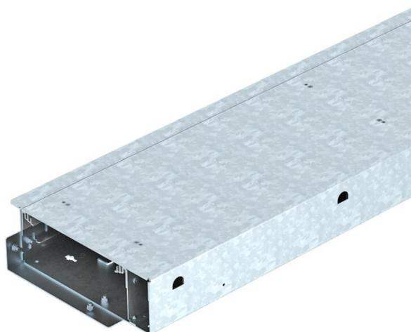
Montagefertige Kanaleinheit zur Leitungsführung und zum Geräteeinbau, bestehend aus einem Kanalunterteil mit zwei Blinddeckeln. Im Lieferumfang enthalten sind zwei Deckelstoßdichtungen und ein Verbinder. Zur Höheneinstellung werden sechs Nivelliereinheiten benötigt. Bis maximal 5 kN belastbar. Die Kanaleinheit kann mit ein verstellbaren Bodenbelagsanlegeprofil zur Estrichabgrenzung in Bereichen von Türailbungen und vor Heizkörpernischen ergänzt werden.
