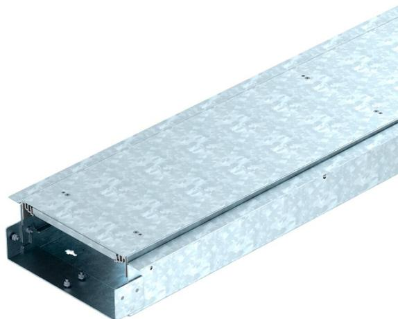
Montagefertige Kanaleinheit zur Leitungsführung, bestehend aus einem Kanalunterteil mit zwei Deckeln. Im Lieferumfang enthalten sind zwei Deckelstoßdichtungen und ein Verbinder. Zur Höheneinstellung werden sechs Nivelliereinheiten benötigt. Bis maximal 5 kN belastbar. Die Kanaleinheit kann mit ein verstellbaren Bodenbelagsanlegeprofil zur Estrichabgrenzung in Bereichen von Türleibungen und vor Heizkörpernischen ergänzt werden.
