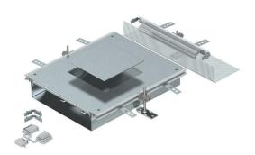
Montagefertige Kanalanbaueinheit mit einem Geräteeinbaudeckel zum Einbau einer Einbaueinheit der Nenngröße 4, bestehend aus Kanalunterteil (Bodenwanne mit Seiten- und Bodenbelagsanlegeprofilen), Kanaldeckel mit blind verschlossener Montageöffnung und einem Kanalendstück. Im Lieferumfang enthalten sind 3 höhennivellierbare Befestigungswinkel, 3 Estrichanker, 1 Deckelstoßunterstützung und 1 Bausatz für Winkelabzweig
