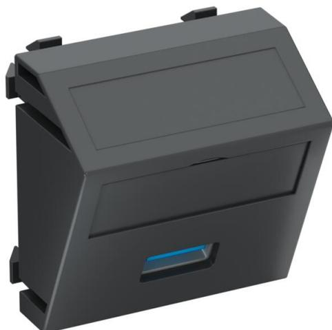
Multimediaträger mit einer USB 3.0-Anschlussbuchse, Kabelauslass schräg, mit Beschriftungsfeld, USB 3.0-Buchse Typ A mit Schraubanschluss. Trägerplatte mit Rastbefestigung, geeignet für den waagerechten und senkrechten Einbau in die Systemumgebung.
