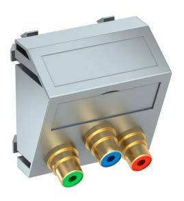
Multimediaträger mit drei Cinch-Anschlussbuchsen für Component Video, Kabelauslass schräg, mit Beschriftungsfeld, drei Cinch-Kupplungen (RCA) in Ausführung Buchse-Buchse, Farbkodierung rot/grün/-blau. Trägerplatte mit Rastbefestigung, geeignet für den waagerechten und senkrechten Einbau in die Systemumgebung.
