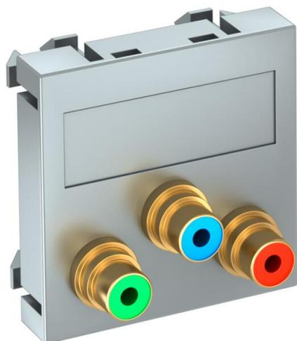
Multimediaträger mit drei Cinch-Anschlussbuchsen für Component Video, Kabelausschluss gerade, mit Beschriftungsfeld, drei Cinch-Kupplungen (RCA) in Ausführung Buchse-Buchse, Farbkodierung rot/grün/blau. Trägerplatte mit Rastbefestigung, geeignet für den waagerechten und senkrechten Einbau in die Systemumgebung.
