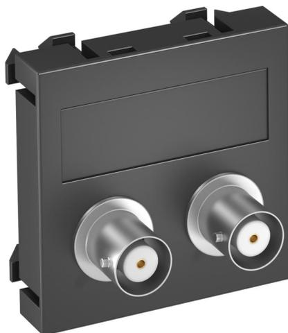
Multimediaträger mit zwei BNC Anschlussbuchsen, Kabelauslass gerade, mit Beschriftungsfeld, zwei BNC Kupplungen in Ausführung Buchse-Buchse. Trägerplatte mit Rastbefestigung, geeignet für den waagerechten und senkrechten Einbau in die Systemumgebung.
