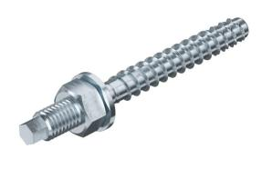
Schraubanker zur direkten Montage ohne Dübel in gerissenem und ungerissenem Beton sowie Mauerwerk. Mit Anschlussgewinde und Unterlegscheibe zur Aufnahme großer Lasten. Geeignet für die Befestigung von Hängestielen und Wandauslegern in Durchsteckmontage.
