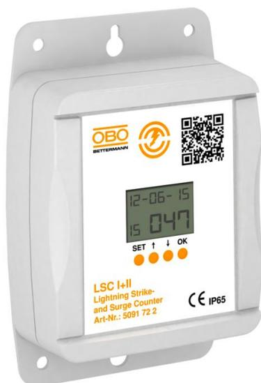
Der Blitzstromzähler LSC I+II erfasst Impulsströme und speichert diese samt Uhrzeit und Datum fest ab. Somit findet eine ständige Kontrolle statt, ob ein Blitz in das Blitzschutzsystem eingeschlagen hat. Sollte dies der Fall sein, so muss nach VDE 0185-305 (IEC 62305) das Blitzschutzsystem gewartet werden.
