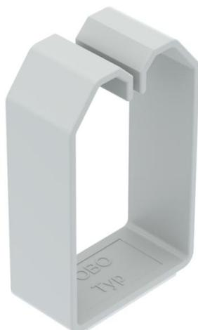
Kabelhalteklammer für LKV-Verdrahtungskanäle. Die Kabelhalteklammer umfasst alle im Kanal installierten Leitungen und verhindert das Herausfallen beim Abnehmen der Oberseite. Mit Klebeband an der Unterseite zur Montage. Zum einfachen Verlegen der Kabel.
