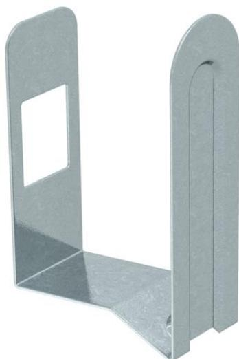
Die Kanalklammer hält die eingelegten Kabel und Leitungen im Kanal und erleichtert somit die Installation an Wand und Decke. Die Kanalklammern werden auf die Schlaufenlochung aufgesteckt und an der Seitenwand eingerastet. Passend für Kanalbreite 100 mm.
