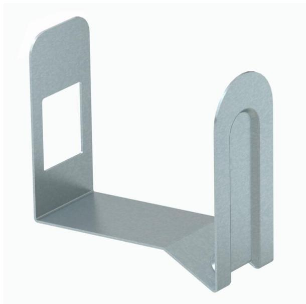
Die Kanalklammer hält die eingelegten Kabel und Leitungen im Kanal und erleichtert somit die Installation an Wand und Decke. Die Kanalklammern werden auf die Schlaufenlochung aufgesteckt und an der Seitenwand eingerastet. Passend für Kanalbreite 80 mm.
