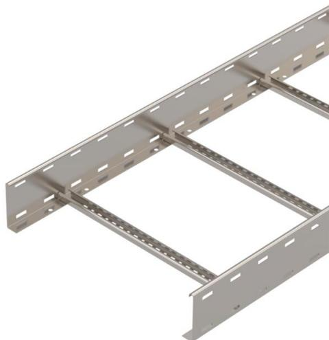
Kabelleiter mit gelochtem Seitenholm in der Seitenhöhe 110 mm mit eingewinkelten, nach oben offenen C-Profil-Sprossen.
