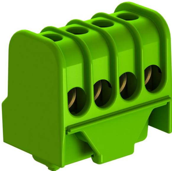
Schutzleiter- Anschlussklemme Klemmleiste aus Messing, Schrauben Stahl, galvanisch verzinkt und transparent passiviert, Nennquerschnitt  $6 \div 16 \text{ mm}^2$ , Nennspannung 400 V, 1-polig, mit Buchsenklemmen max. anschließbare Leiter je Klemmstelle max.  $4 \times 16 \text{ mm}^2$ ,  $4 \times 10 \text{ mm}^2$ ,  $8 \times 6 \text{ mm}^2$  oder  $12 \times 4 \text{ mm}^2$ .
