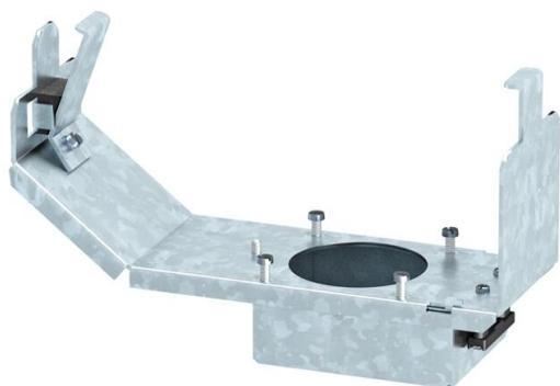
Geräteträger der Nenngröße 3 für den Einbau einer CEE-Steckverbindung 16 A oder 32 A zum Einbau in Geräteinsätzen und Kassetten der Nenngröße R7, 9 und R9. Geräteträger mit Schutzgehäuse und Zugentlastung. Benötigte Mindesteinbautiefe: 190 mm bei Verwendung eines Geradeaus-Steckers und 160 mm bei Verwendung eines Winkelsteckers.
