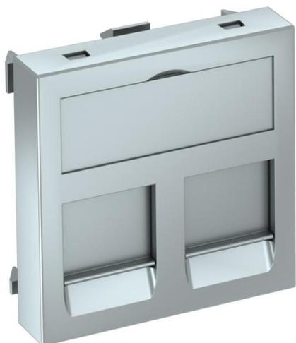
Datentechnikträger mit geradem Auslass und Verschlusschieber zur Aufnahme von zwei Datentechnik-Anschlussmodulen mit RJ45-Buchse. Die Rastbefestigung eignet sich für den waagerechten und senkrechten Einbau in die Systemumgebung. Typ C hat eine Montageöffnung von 19,30 X 14,80 mm und ist für die direkte Befestigung der Daten-Anschlussmodule in der Montageöffnung ausgelegt.
