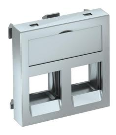
Datentechnikträger mit geradem Auslass, ohne Verschlussschieber, zur Aufnahme von zwei Datentechnik-Anschlussmodulen mit RJ45-Buchse. Die Rastbefestigung eignet sich für den waagerechten und senkrechten Einbau in die Systemumgebung. Typ C hat eine Montageöffnung von 19,30 X 14,80 mm und ist für die direkte Befestigung der Daten-Anschlussmodule in der Montageöffnung ausgelegt.
