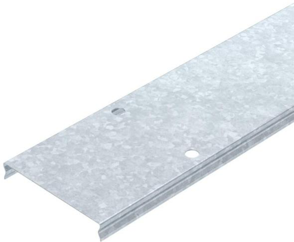
Rastbarer Deckel für Gitterrinnen Typ GR und GRM. Schützt Kabel und Leitungen vor Beschädigungen und Verunreinigungen und Feuchtigkeit von oben. Für industrielle Bereiche wie Maschinen- und Anlagenbau geeignet. Mit Quersicken ab 400 mm Breite. Bei Verwendung von Deckeln im Außenbereich sind unter Umständen zusätzliche Maßnahmen gegen Windeinflüsse vorzunehmen.
