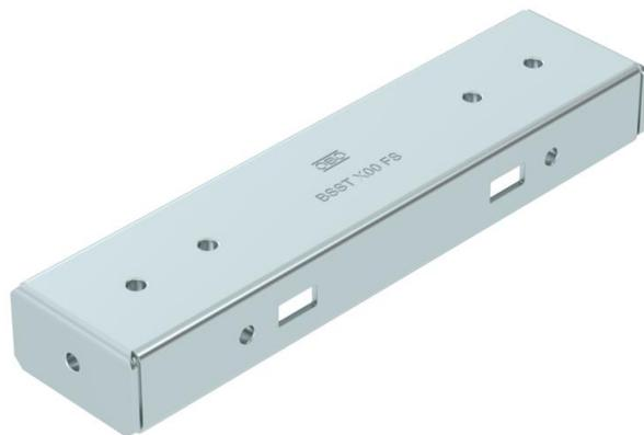
Traverse der symmetrischen Bodenstütze für das BKRS-System, passend für Unterteil Typ BSSU 190 2030. Einsetzbar für begehbare Kabelrinnen Breite 200 mm. Mit Gewindedurchzügen zum spanlosen Montieren von Kabelrinnen. Befestigung an Unterteil mit 4x FKS Flachkopfschraube M6. Befestigungsmaterial muss separat bestellt werden.
