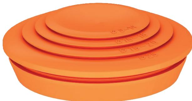
Die weiche Einsteckdichtung kann durch stufenweises Abschneiden dem jeweiligen Kabeldurchmesser angepasst werden.
