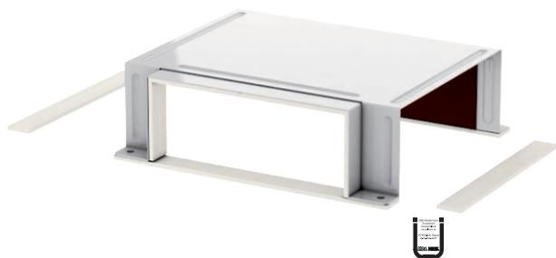
Haube zur Abdeckung einer T-förmigen Anordnung von drei zueinander laufenden Kanälen BSKM 1025. Inklusive eingeklebter Dichtungen zum Abdichten der Fugen und losen Dichtungen bei Kombination mit Gegenplatte, sowie Schrauben für den Potentialausgleich.
