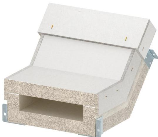
Vertikalbogen steigend für Brandschutzkanal PYROLINE® Con S, Typ BSKH09-K0521 bestehend aus wasser- und frostbeständigen Glasfaserleichtbeton zur Herstellung von vertikalen Richtungsänderungen (45°) im Kanalverlauf. Fertig montierte Verbindungsbeschläge sorgen für eine schnelle Montage vor Ort, lose aufgelegte Deckel für eine schnelle Revision und Nachbelegung. Inklusive Verbindungsschrauben und Dichtungstreifen.
