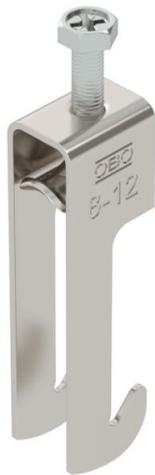
Bügelschelle mit W-Fuß, Metalldruckwanne mit gerundeten Kanten für Kabelschutz. Zur vertikalen und horizontalen Montage von 1 Einzelkabel an Winkelisen bis < 40 mm. Mit 1-gängiger Schraube an Druckwanne, universeller Sechskant-Schraubenkopf SW10, mit Schlitz und Kreuzschlitz. Geeignet für Montage im Innen- und Außenbereich. Der Einsatz einer Gegenwanne wird empfohlen.
