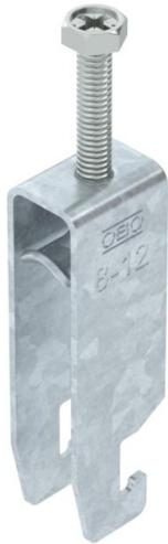
Bügelshelle mit U-Fuß, Metalldruckwanne mit gerundeten Kanten für Kabelschutz. Zur vertikalen und horizontalen Montage von 3 Einzelkabeln an C-Profil-schiene. Für Schlitzweite 18 - 22 mm. Mit 1-gängiger Schraube an Druckwanne, universeller Sechskant-Schraubenkopf SW10, mit Schlitz und Kreuzschlitz. Geeignet für Montage im Innen- und Außenbereich. Mehrere Kabel sollten durch Doppelwannen getrennt werden. Der Einsatz einer Gegenwanne wird empfohlen.
