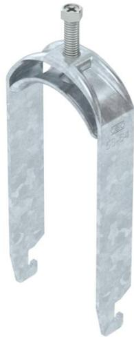
Bügelschelle mit U-Fuß, Metalldruckwanne mit gerundeten Kanten für Kabelschutz. Zur vertikalen und horizontalen Montage von 2 Einzelkabeln an C-Profil-schiene. Für Schlitzweite 18 - 22 mm. Mit 1-gängiger Schraube an Druckwanne, universeller Sechskant-Schraubenkopf SW10, mit Schlitz und Kreuzschlitz. Geeignet für Montage im Innen- und Außenbereich. Mehrere Kabel sollten durch Doppelwannen getrennt werden. Der Einsatz einer Gegenwanne wird empfohlen.
