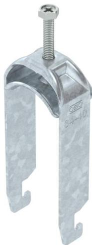
Bügel­schelle mit U-Fuß, Metall­druckwanne mit gerundeten Kanten für Kabel­schutz. Zur vertikalen und horizontalen Montage von 2 Einzelkabeln an C-Profil­schiene. Für Schlitzweite 18 - 22 mm. Mit 1-gängiger Schraube an Druckwanne, universeller Sechskant-Schraubenkopf SW10, mit Schlitz und Kreuzschlitz. Geeignet für Montage im Innen- und Außenbereich. Mehrere Kabel sollten durch Doppelwannen getrennt werden. Der Einsatz einer Gegenwanne wird empfohlen.
