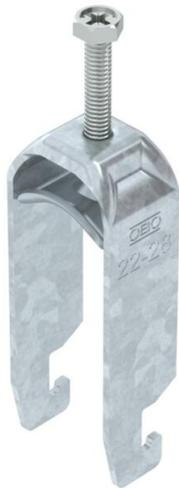
Bügelshelle mit U-Fuß, Metalldruckwanne mit gerundeten Kanten für Kabelschutz. Zur vertikalen und horizontalen Montage von 2 Einzelkabeln an C-Profilshiene. Für Schlitzweite 18 - 22 mm. Mit 1-gängiger Schraube an Druckwanne, universeller Sechskant-Schraubenkopf SW10, mit Schlitz und Kreuzschlitz. Geeignet für Montage im Innen- und Außenbereich. Mehrere Kabel sollten durch Doppelwannen getrennt werden. Der Einsatz einer Gegenwanne wird empfohlen.
