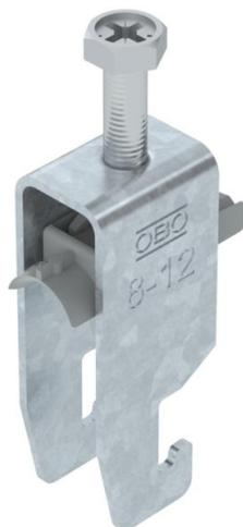
Bügel­schelle mit U-Fuß, Kunststoffdruckwanne aus Polypropylen. Zur vertikalen und horizontalen Montage von 2 Einzelkabeln an C-Profilschiene. Für Schlitzweite 18 - 22 mm. Mit 1-gängiger Schraube an Druckwanne, universeller Sechskant-Schraubenkopf SW10, mit Schlitz und Kreuzschlitz. Geeignet für Montage im Innen- und Außenbereich. Mehrere Kabel sollten durch Doppelwannen getrennt werden. Der Einsatz einer Gegenwanne wird empfohlen.
