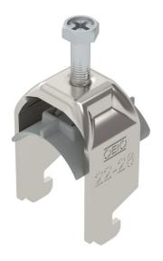
Bügelschelle mit N-Fuß, Kunststoffdruckwanne aus Polypropylen. Zur vertikalen und horizontalen Montage von 1 Einzelkabel an C-Profilschiene. Für Schlitzweite 11 - 12 mm. Mit 1-gängiger Schraube an Druckwanne, universeller Sechskant-Schraubenkopf SW10, mit Schlitz und Kreuzschlitz. Geeignet für Montage im Innen-und Außenbereich. Der Einsatz einer Gegenwanne wird empfohlen.
