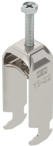
Bügelshelle mit Hammerkopf-Fuß, Metalldruckwanne mit gerundeten Kanten für Kabelschutz. Zur vertikalen und horizontalen Montage von 2 Einzelkabeln an C-Profilshiene. Für Schlitzweite 16 - 17 mm. Mit 1-gängiger Schraube an Druckwanne, universeller Sechskant-Schraubenkopf SW10, mit Schlitz und Kreuzschlitz. Geeignet für Montage im Innen- und Außenbereich. Mehrere Kabel sollten durch Doppelwannen getrennt werden. Der Einsatz einer Gegenwanne wird empfohlen.
