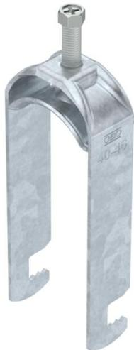
Bügelshelle mit F-Fuß, Metalldruckwanne mit gerundeten Kanten für Kabelschutz. Zur vertikalen und horizontalen Montage von 2 Einzelkabeln an Flacheisen. Mit 1-gängiger Schraube an Druckwanne, universeller Sechskant-Schraubenkopf SW10, mit Schlitz und Kreuzschlitz. Geeignet für Montage im Innen- und Außenbereich. Mehrere Kabel sollten durch Doppelwannen getrennt werden. Der Einsatz einer Gegenwanne wird empfohlen.
