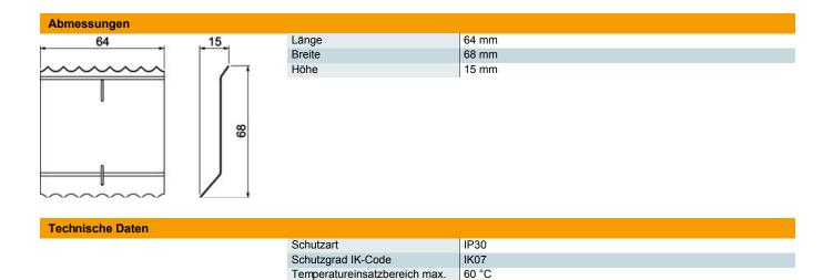
Temperatureinsatzbereich min. Ausführung Potentialausgleich Geräteeinbaukanal -5 °C
