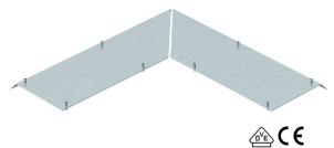
Blinddeckel 2-teilig zum Abdecken des Außenecks eines Aufbodenkanals, passend zu den Kanalunterteilen AlK/U inkl. 10 Befestigungsschrauben. Der Kanaldeckel wird in den Al-Seitenprofilen des Kanalunterteils festgeschraubt. Die Deckelschräge überragt das Kanalunterteil im 45°-Winkel.
