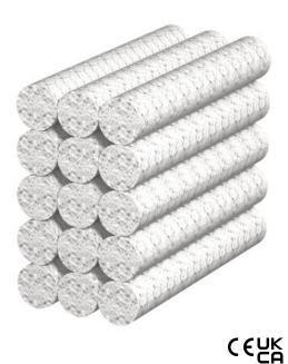
Die Schallschutzbarriere dient zur Minderung der Luftschall-Übertragung z. B. bei Führung des Kanalsystems durch Wanddurchbrüche zwischen zwei Büros. Die Schallschutzbarriere besteht aus Glaswolle, die im Lieferzustand einen Durchmesser von ca. 30 mm und eine Länge von ca. 300 mm hat. Das Material braucht bei der Montage nicht extrem komprimiert zu werden. Die Dämpfung beträgt ca. 40 dB.
