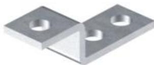
• Zum Anschluss an Stahlkonstruktionen oder zum Anschrauben an Erdungsfestpunkte • Für Anschlüsse: Rundleiter Rd 8-10 und Flachleiter FL30 x 3,5 • 2 x Anschlusslöcher  $\varnothing$  11 mm • 1 x Anschlussloch  $\varnothing$  D mm
