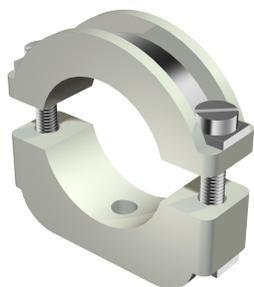
Blitz-Iso-Schellen: Kunststoffschelle mit Metalleinlage, daher auch für schwere Beanspruchung geeignet; Metallteile aus Stahl, galvanisch verzinkt. Aufschraubbar auf Gewinde M6.
