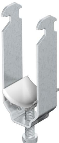
Passend zu allen C-Profilshienen mit 16 - 17 mm Schlitzweite; Schelle und Schraube aus Aluminium ALMg 3, Druckwanne aus Polypropylen, halogenfrei, lichtgrau RAL 7035.
