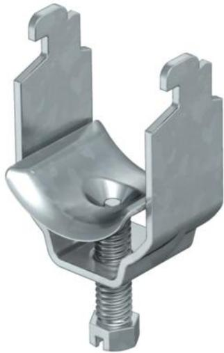
Passend zu allen C-Proflschienen mit 11 - 12 mm Schlitzweite; mindestens 6,5 mm lichter Innenhöhe und mindestens 18,5 mm lichter Innenbreite; Metallwannen haben allseitig stark gerundete Kanten, sodass keine Kabelbeschädigung zu befürchten ist. Ausführung mit Anschweiß- und/oder Kontermutter für Einsatz unter erschwerten Bedingungen sowie für Rüttelsicherheit auf Anfrage!
