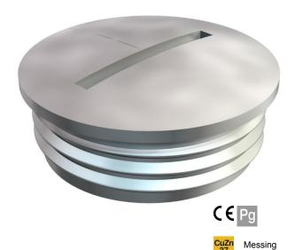
Verschlussschraube N nach DIN 46320, mit PG-Gewinde nach DIN 40430. In Verbindung mit Dichtring Typ 107, 170 oder 171 Schutzart IP 68 (5 bar/1 h). Dichtring ist nicht im Lieferumfang enthalten.
