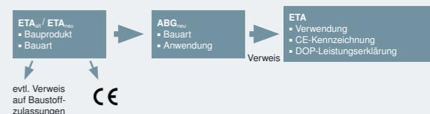
Abbildung 2: Vorgehen bei CE-gemarkneten Bauprodukten mit ETA
