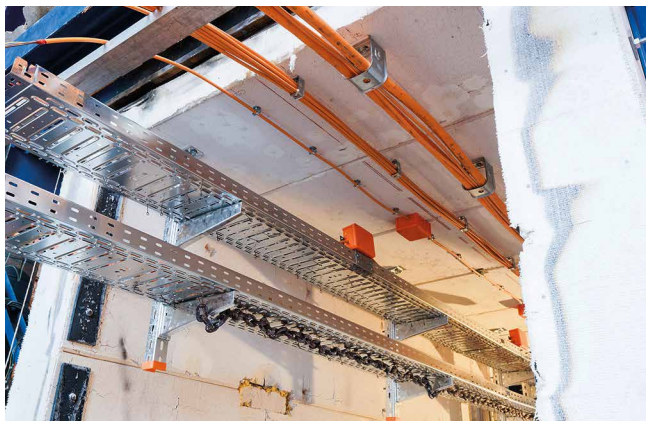
Prüfaufbau einer Kabelanlage in einem Prüfofen
