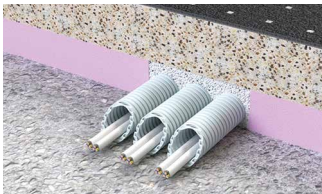
Leitungsverlegung unterhalb des Estrichs
