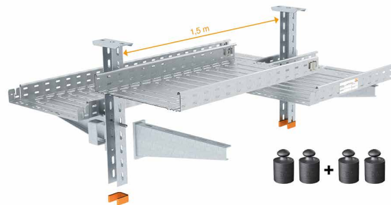
Beispiel einer kabelspezifischen Tragekonstruktion mit Kabelrinnen ohne Gewindestangensicherung
