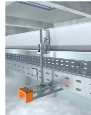
Befestigung des Tragsystems an unbeschichteten Stahlträgern mit Trägerklammern
