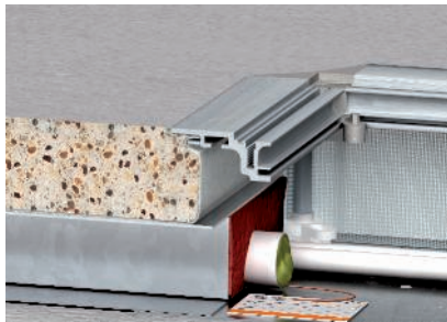
Gekennzeichnete, mit Reserve-Leerrohr versehene Unterflur-Abschottung.
