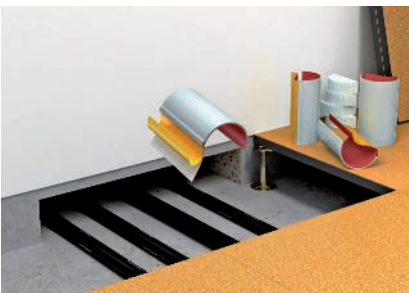
Montage der Halbschale.
