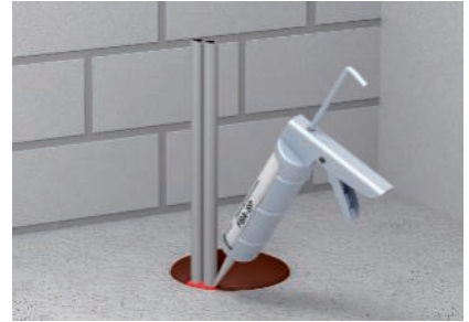
Restfugen werden mit der Spachtelmasse FBA-SP verschlossen.
