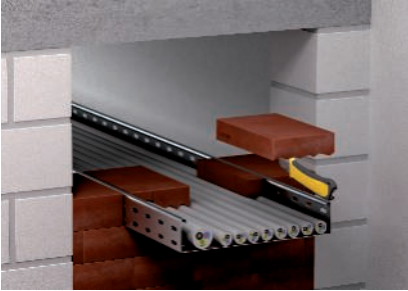
Montage der zugeschnittenen Blöcke.
