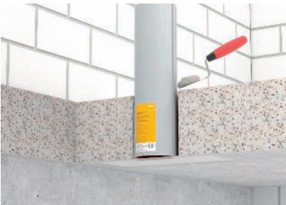
Bei Deckenmontage Schalung verwenden, um ein Herausfallen der Rohrschale zu verhindern.
