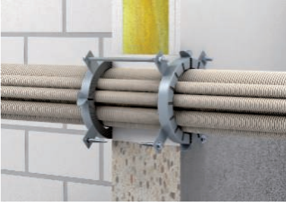
Beidseitige Anordnung der Rohrmanschetten bei Wandmontage.
